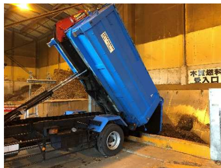
【木屑ホッパに汚泥を投入】
